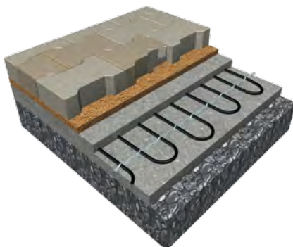
Posa finitura autobloccanti
