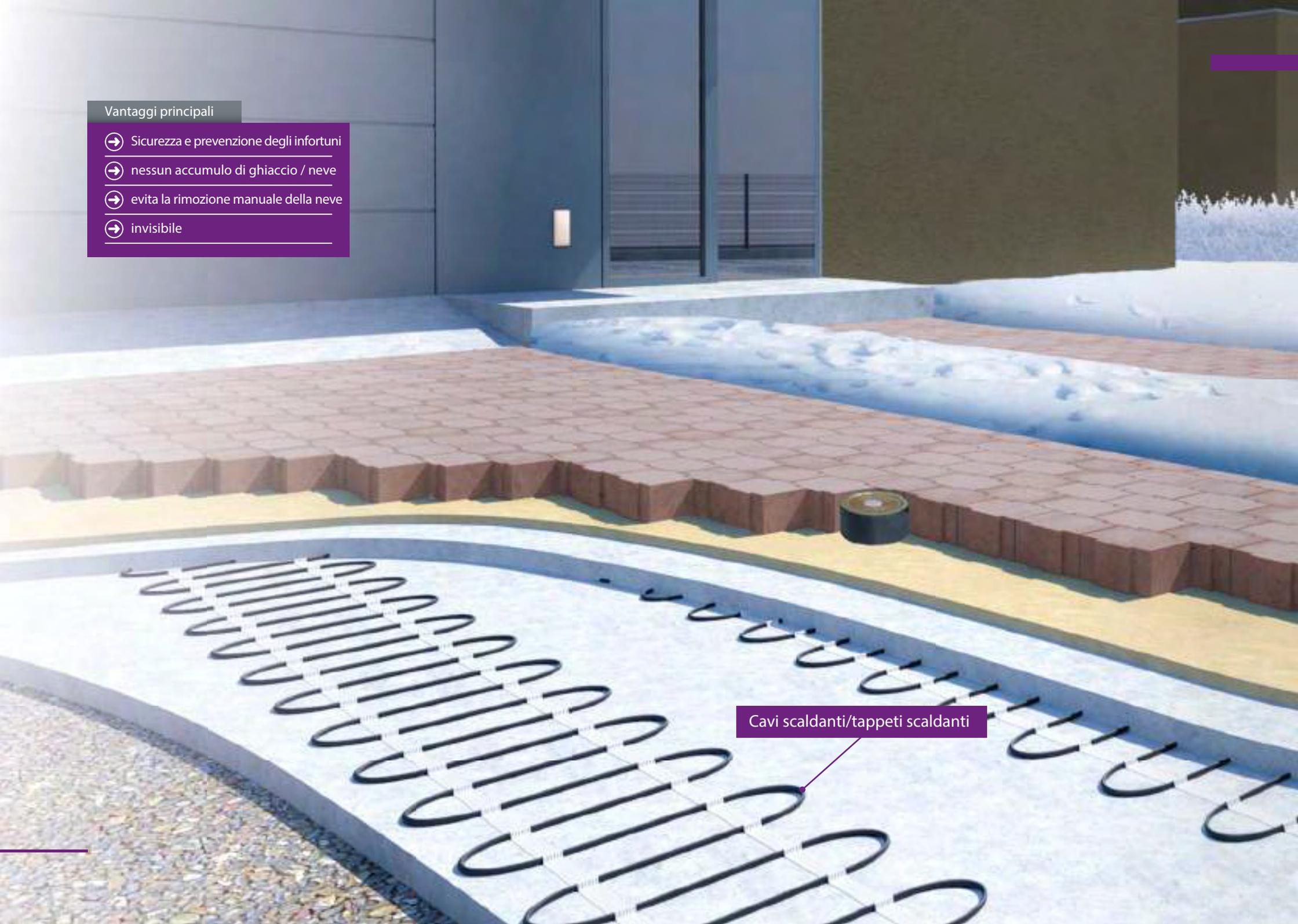
Cavi scaldanti/tappeti scaldanti
