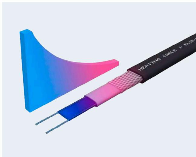
Sebbene i cavi scaldanti autoregolanti cambino automaticamente la loro potenza a seconda della temperatura ambiente, **non si spengono mai completamente.** Per un funzionamento economico è quindi necessario un termostato.
