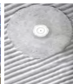
Rasatura conica per facilitare l'ingresso acqua nel sensore
